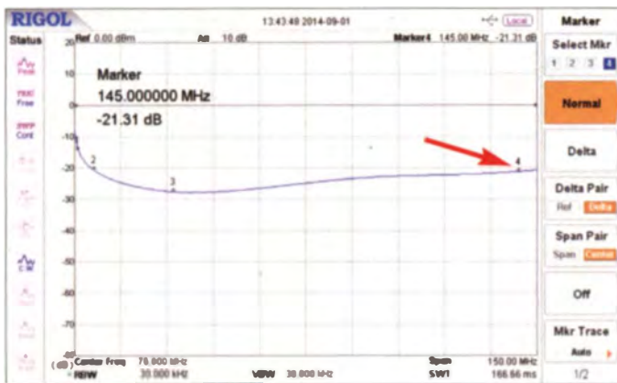
Bild 6: Verstärkung des SGA6489 im Frequenzbereich 1,8 MHz bis 150 MHz
