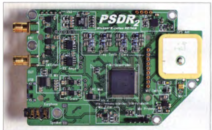
Auf der Hauptplatine des Portable SDR ist unter anderem auch ein GPS-Empfänger integriert.
