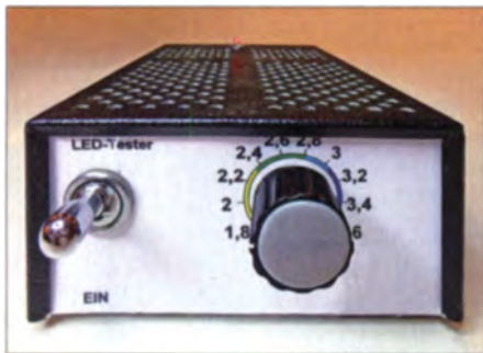
Bild 1: Frontansicht des LED-Testers mit den Spannungs- und Farbangaben Fotos: DK7VN
