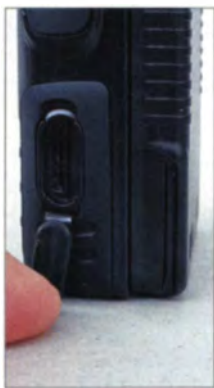
Bild 3: Neben der üblichen Mikrofon- und Stromversorgungsbuchse gibt es eine spezielle Datenbuchse, an der auch das optionale Kamera-Mikrofon MH-85A anzustecken ist.
