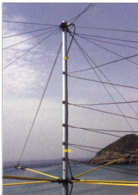
Bild 10: Das runde Rohr dient zur Speisung und als Spannturm für die Spreizer.
