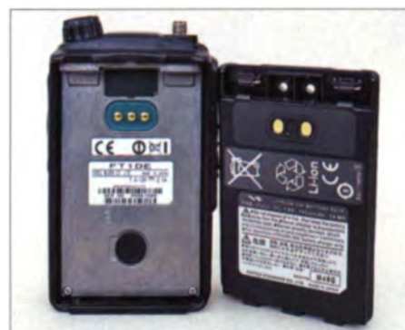
Bild 2: Im Lieferumfang von WiMo befindet sich die mit 1,8 Ah Kapazität ausdauerndere Akkumulatorvariante.
