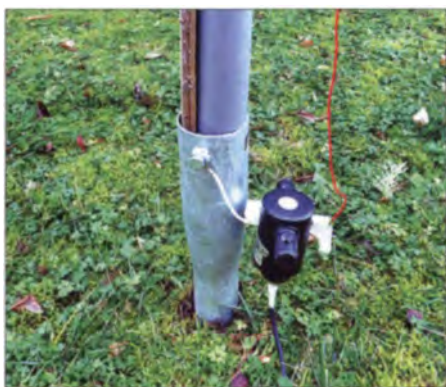
Bild 1: Die Bodenhülse dient zugleich zur Kontaktierung des Baluns. Fotos: DL7VEE
