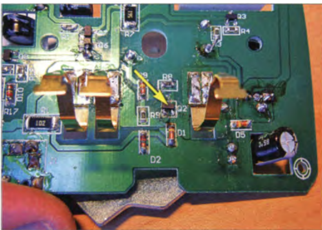
Position des Transistors Q2 im Ladegerät CD-41; es ist genügend Platz vorhanden, um das SMD-Bauteil ohne Beschädigung der umliegenden Bauteile aus- und einen neuen Transistor wieder einzulöten.
