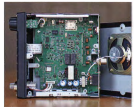
Bild 2: Das neue stabo xm 4060e empfängt und sendet in FM und AM. Fotos: DL1ABJ
