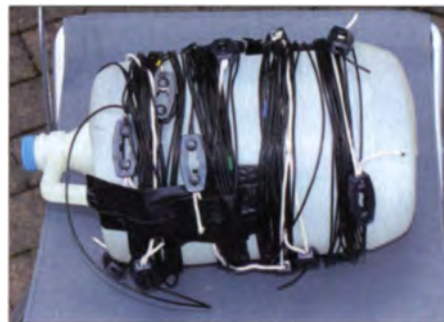
Bild 14: Fertig zusammengestellte Drahtelemente (eine komplette Wicklung je Band)
