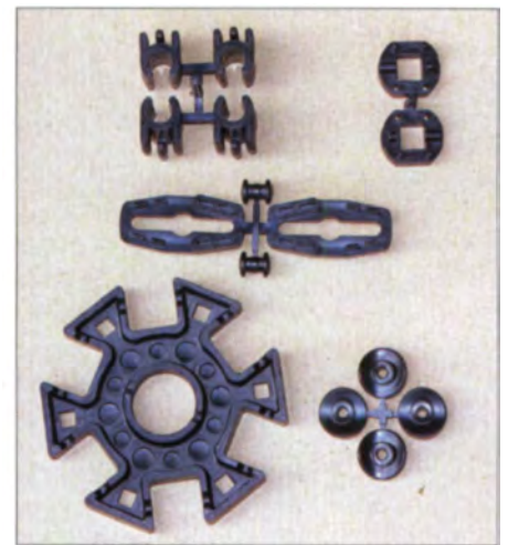
Bild 9: Spezialbauteile aus Spritzguss für den „Regenschirm“-Beam
