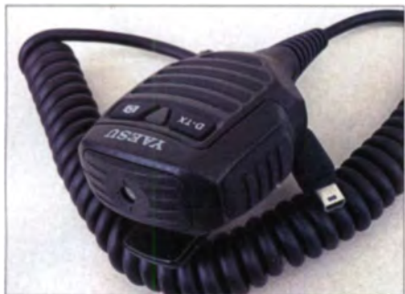
Bild 7: Das optionale Mikrofon MH-85A verfügt über eine eingebaute Kamera, jedoch mit vergleichsweise geringer Auflösung.
