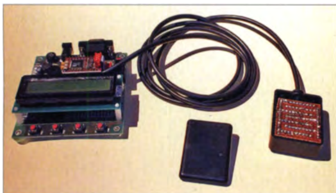
Bild 1: Der Feuchtesensor (rechts) lässt sich als kleines Gerät im Boden versenken. Der Sensor wurde hier aus einer Universalleiterplatte mit kammförmig verbundenen Löt-äugen hergestellt.
