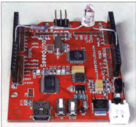
Bild 8: Bei diesem Versuchsaufbau steuert der Arduino eine LED an. Foto: Sander
