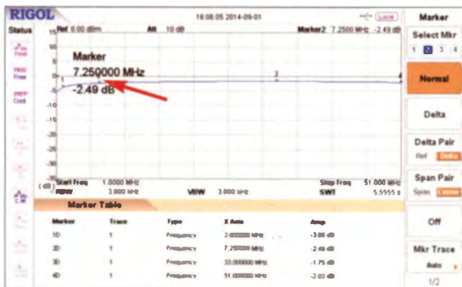
Bild 8: Eingangsrückflussdämpfung des Verstärkers mit SGA6489 bei offenem Ausgang
