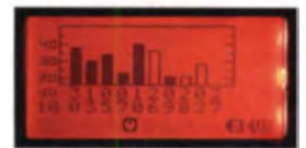
Bild 15: Empfang von sechs GPS-Satelliten innerhalb des Hauses
