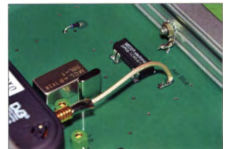
Bild 4: Blick auf das Koaxialkabel und die Masseverbindung zum Gehäuse
