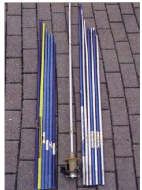
Ausgediente Skistöcke aus Glasfaser (hier links im Bild) eignen sich gut als Träger für Vertikalantennen. Foto: DG1VR
