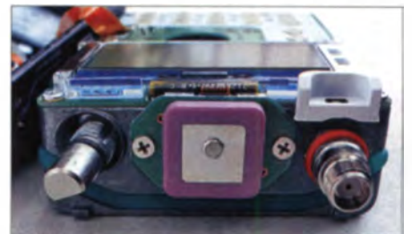
Bild 6: Die GPS-Antenne an der Oberseite ist im Inneren gut erkennbar.
