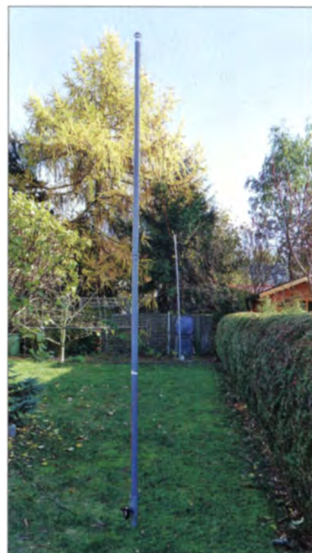
Bild 3: Als 4 m hohe Stützen der EWE-Antennen dienen hier je zwei 2 m lange HT-Rohre.
