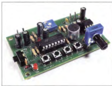
Bild 2: Bestücktes und getestetes Modul; Abmessungen 49 mm x 67 mm
