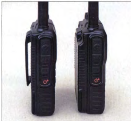
Bild 10: Gegenüber dem Standard-Akkumulator mit 1,1 Ah wird das Gerät deutlich dicker, was sich durch Weglassen des Gürtelclips etwas kompensieren lässt.
